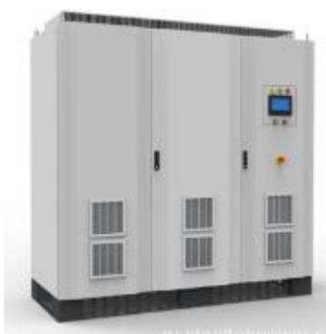
МТР - 0900 - 0500Т - это изделие с номинальной выходной мощностью 450 кВт в семействе блоков питания серии МТР. Он использует промышленный шкаф 2100 \* 2150 \* 800 и сенсорный ЖК-экран для программируемого управления и мониторинга.
